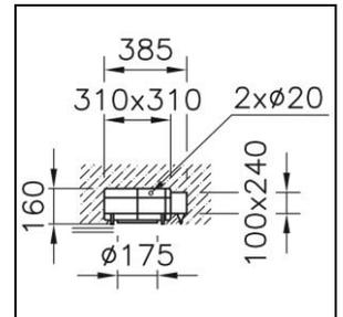
Einbetoniergehäuse B.Box aus Kunststoff, rund,
